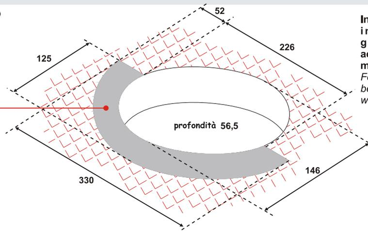
In caso di installazione ad incasso è necessario garantire una corretta aerazione con due griglie min. Ø15cm.
