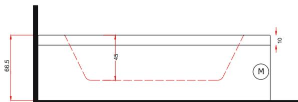
Motore Idromassaggio (M) Whirlpool Motor
